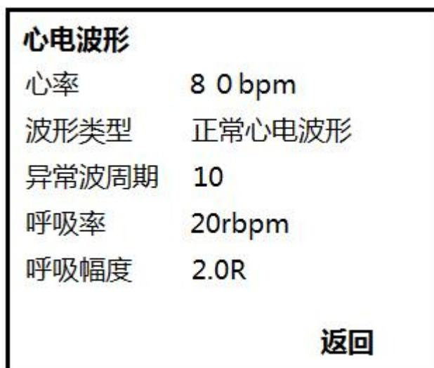
**心 率：**设置正常心电波形的心率值，设置范围 10bpm-300bpm，同步输出 12 导心电波形；
