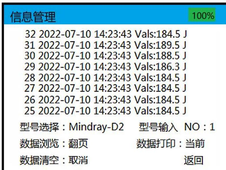
**型号选择：**通过旋钮选择准备检测的除颤器的型号，能量检测数值将对应此型号进行保存及打印，数据浏览、数据打印都与此型号选择相关，数据浏览的内容及数据打印的内容都是此型号对应的数据；
