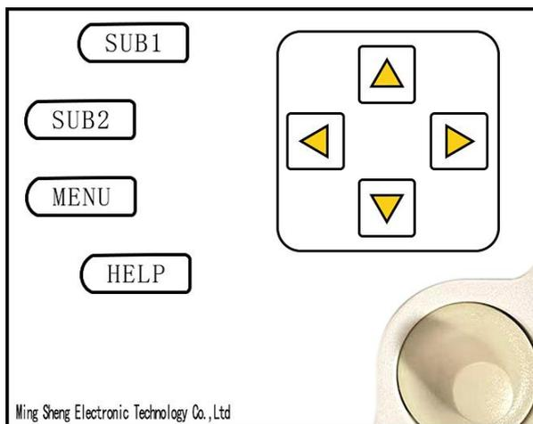
H2-1000KII 的主要操作使用↑上、↓下、←左、→右键进行软件操作,通过左右进行菜单项目选择,可以使用上、下进行数值更改。仪器另外配备了编码器,所有的操作都可以通过编码器进行操作,编码器有 3 种按键状态,左转,右转,回车按键(代表确认)。
