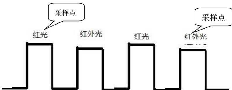
如上述波形类似，已经载有血氧波形数据了，在此情况下，应根据波形幅度的大小来对波形进行放大处理，最后进入到 CPU 的 AD 部分直接进行采集即可，注意的是，不需要把上述波形进行分离了，只需要在 CPU 程序端根据发光部分的时序，在对应的时间点上来采集波形就可以了，建议应该在关闭并切换发光管前来采集 AD 信号，这样最大程度的来得到有效数据，如果脉冲宽度够宽，可以在脉冲的中间点采样也可。
