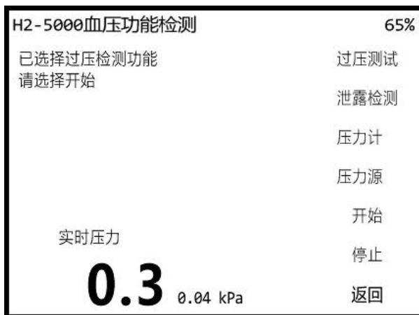
通过 Select 可以依次选择四项静态压力测试功能项目，过压测试，泄漏测试，压力计，压力源，当选择需要的项目后，通过 Start/Stop 键可以对所选择的项目进行开始或者停止。也可以通过移动键和确认键对功能进行选择和开始及停止。
