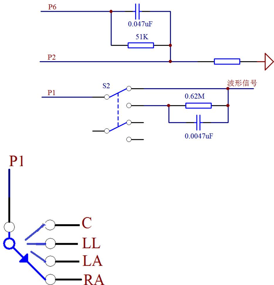
P1 端默认连接 RA，LA、LL、C、RL 默认连接 P2 端，RL 通过控制可以连接 P6 端
