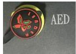
A、除颤仪通过除颤电极连接到上图中的不锈钢电极片上，采集模拟仪发出的除颤仪专用模拟心电波形；
