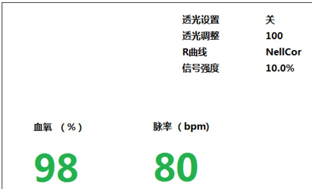
透光设置：当选择关时，模拟仪选择自动调整透光光强，当选择开时，则关闭自动透光强度调整，手动设置透光强度，用于检测血氧类设备的极限值。
