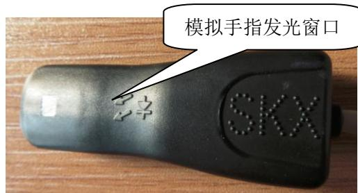
请将模拟手指的这一面（如上图）放置到血氧探头的接收管端
