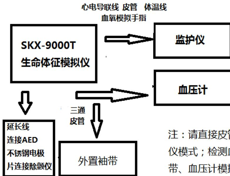
注：请直接皮管连接监护仪并设置模式为监护仪模式；检测血压计时，通过三通连接外置袖带、血压计模拟仪
