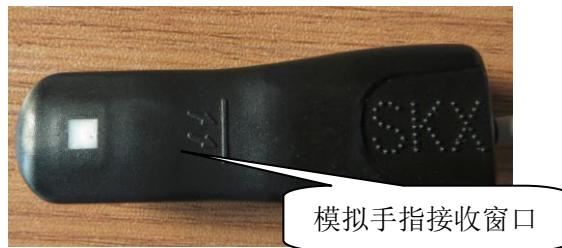
请将模拟手指的这一面（如上图）放置到血氧探头的红色发光管端
